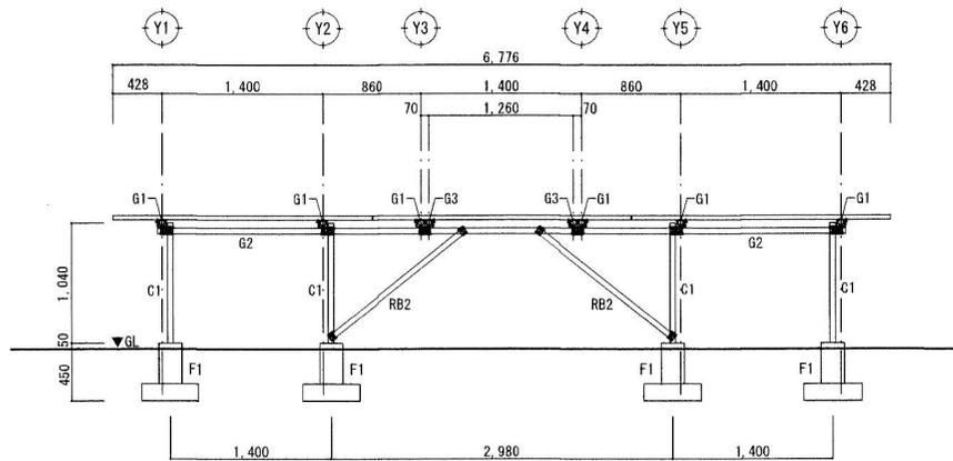
X1通 軸組図 SCALE 1/50
