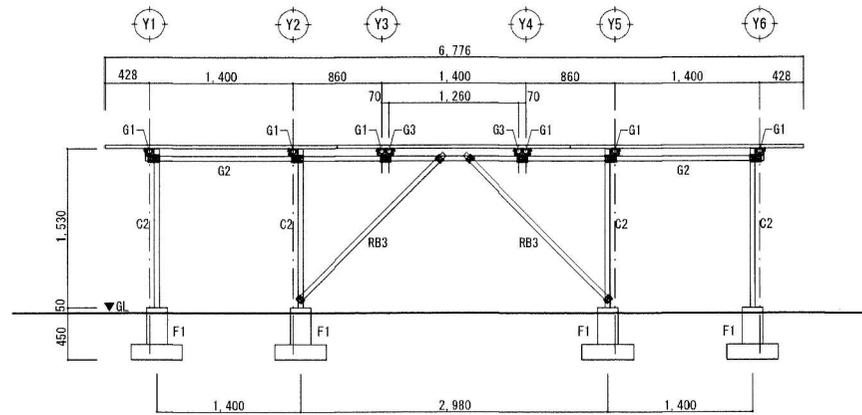
X2通 軸組図 SCALE 1/50
