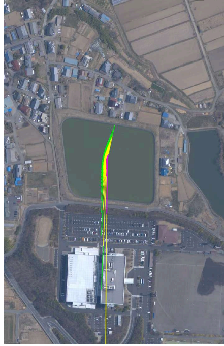
4月 パネル方位東 傾斜 8度
