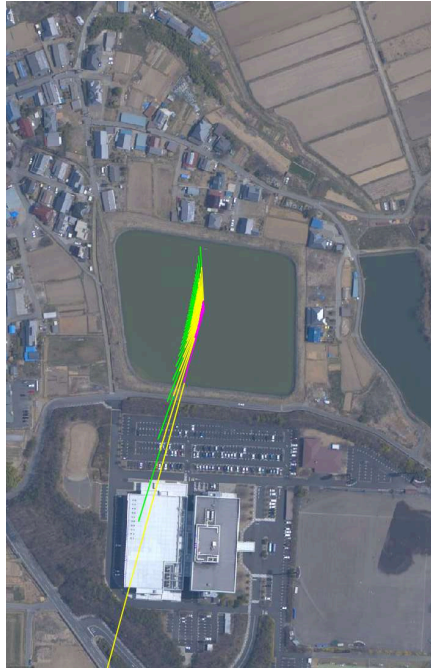
3月 パネル方位東 傾斜 8度
