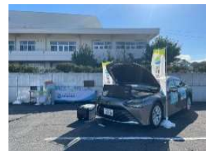
車両から外部給電器を介して給電する様子 (令和6年度長野県総合防災訓練)
