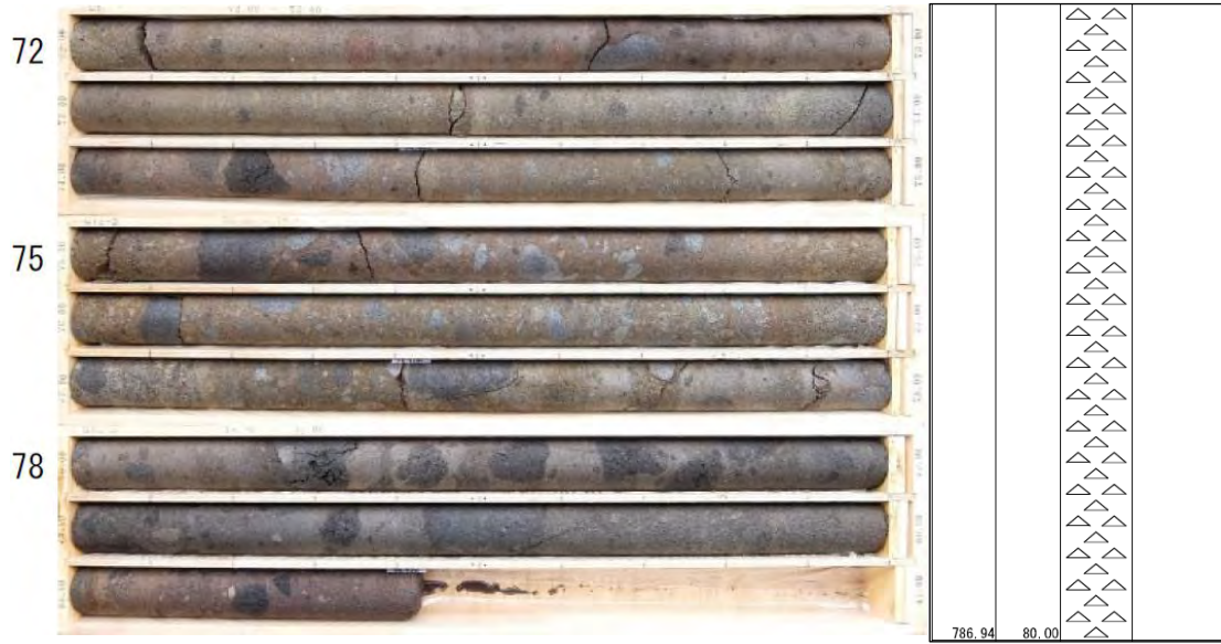
図 5.1-1(9) GY2-2 コア写真及び柱状図 (山梨県)
