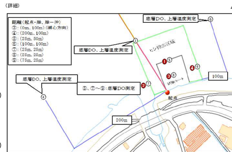
※①～④、⑥は沖合の貧酸素水塊の影響調査、⑤、⑦～⑩は覆砂の効果確認調査
