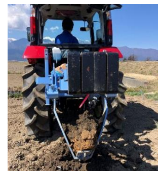
写真13 カットブレーカー
