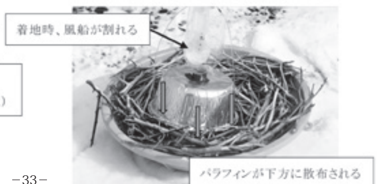
図3 散布の仕組み
