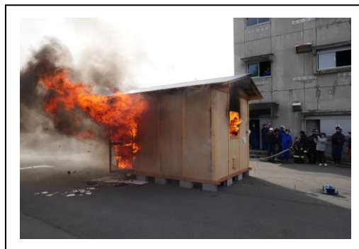
模擬家屋燃焼実験の様子
