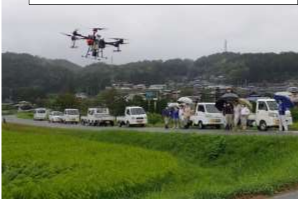
農業用マルチローターによる斑点米防除
