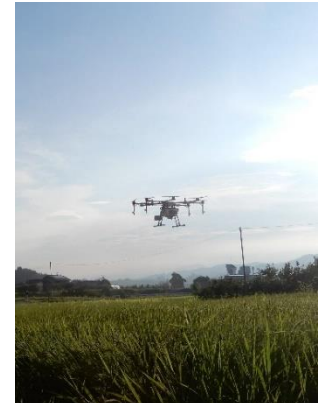
マルチローターによる薬剤散布
