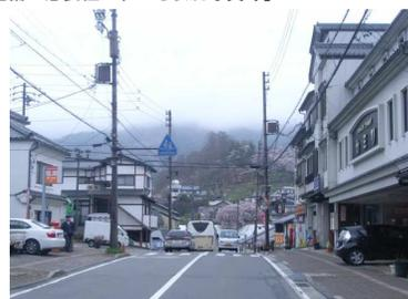
歩道空間に電柱が林立し、上空、商店街の視界を電線が占有している。災害時には、電柱転倒による交通マヒ、住民活動に支障が生じる。
