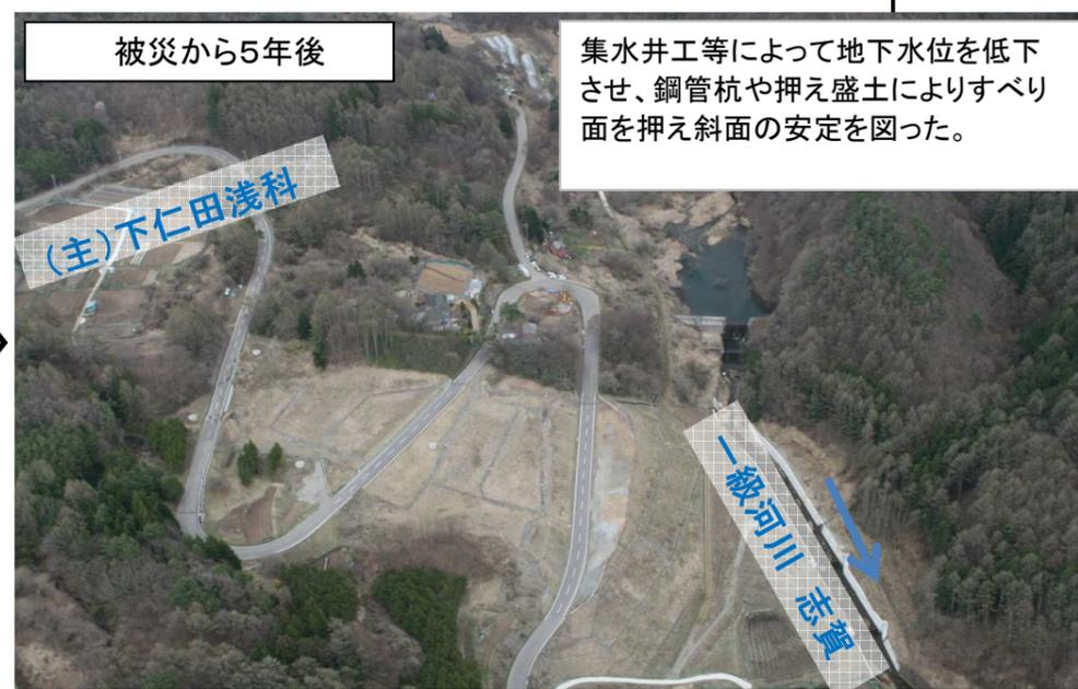
集水井工等によって地下水位を低下させ、鋼管杭や押さえ盛土によりすべり面を押し斜面の安定を図った。
