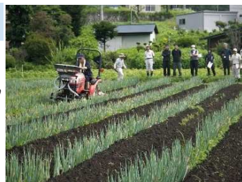
白ネギ栽培における幅狭トラクターを使用した土寄せ（省力化機械）
