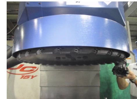
新開発したφ620mm切削工具(左)とφ150mm切削工具
