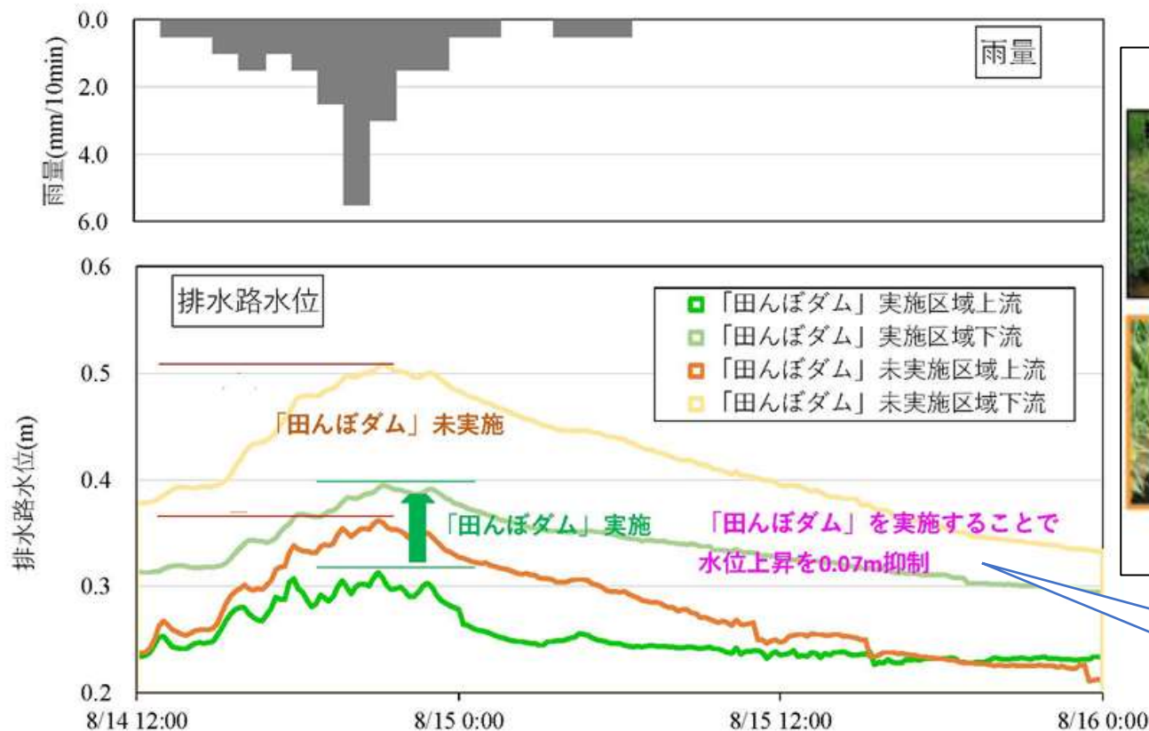
図 11 排水路の水位上昇抑制効果（実証事業 観測結果）
