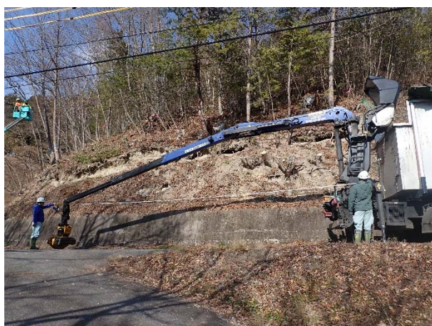
写真2-5 林業用クレーンの計測状況
