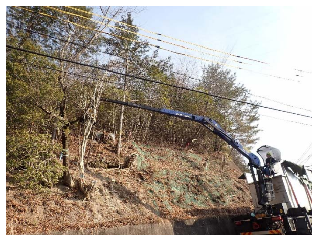
写真 2-3 オペレーター1 名によるヒノキ伐倒作業（左：下條村）と広葉樹伐倒作業（右：阿南町） オペレーターのみで作業が可能で、クレーン旋回範囲内に作業員を常駐させておく必要がないため安全である。
