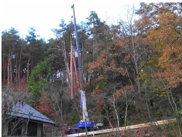
写真 2-6 ラフタークレーンのアカマツ大径木吊るし伐り（松本市）
