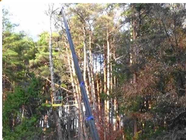
写真 2-1 EWP による伐採作業（左：阿南町）とラフタークレーンによる伐倒作業（右：松本市） EWP には作業員 2 名、ラフタークレーンの搭乗設備には作業員 1 名（ともに安全帯を装着して搭乗）
