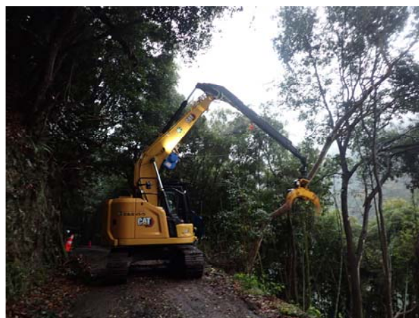
写真 2-12 林業用仕様（重機に装着 GMT050） グラップル機能で竹を引きちぎることもできる （少ない事例）
