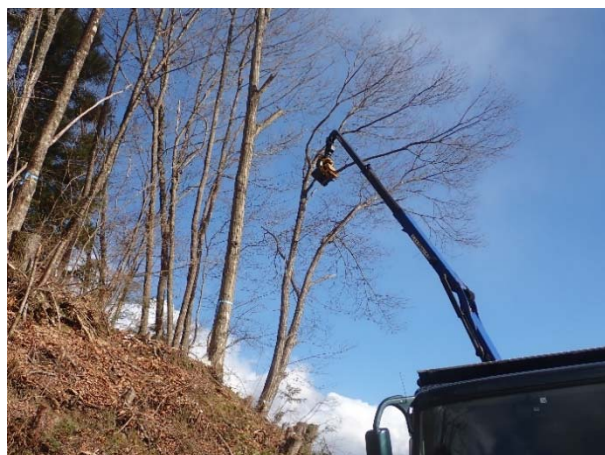
写真 2-7 本作業システムの伐倒（阿南町西條） 複数の樹木の枝を先行して伐倒し、GMTヘッドやクレーンアームの操作・旋回をスムーズに行う
