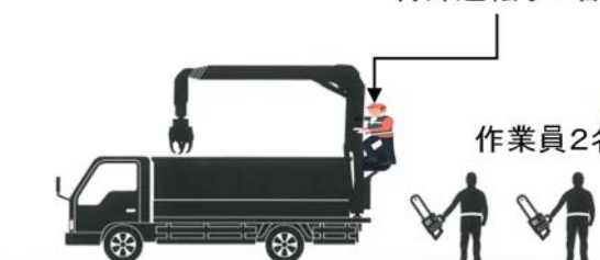
図 3-2 フェリンググラップル作業システムセット人員 (株) 丸光イトウカタログ図を一部改変
