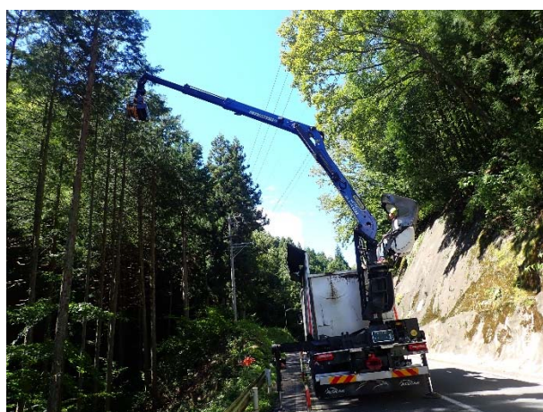
写真 2-3 オペレーター1 名によるヒノキ伐倒作業（左：下條村）と広葉樹伐倒作業（右：阿南町） オペレーターのみで作業が可能で、クレーン旋回範囲内に作業員を常駐させておく必要がないため安全である。
