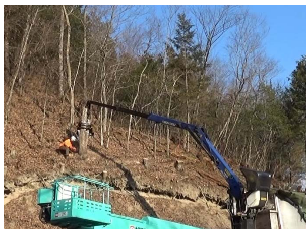
写真 2-10 根元付近のチェーンソー伐倒 支保（補助）
