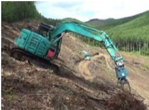
主伐と造林の一貫作業の状況（左写真：機械地拵え、右写真：苗木の機械運搬）
