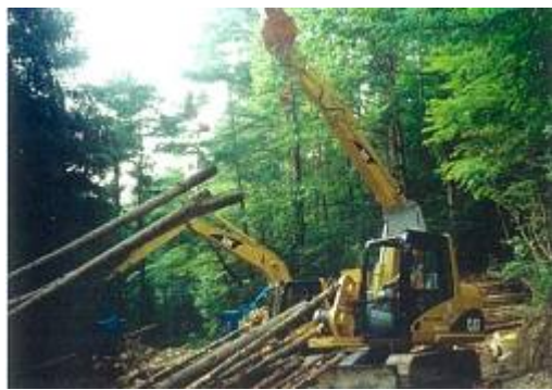
高性能林業機械による搬出間伐
