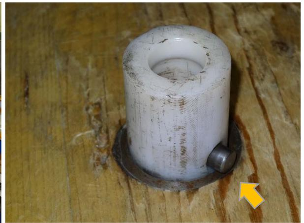
枝払い練習機 ガイドバーを適切に動かすことを覚える。矢印にあてると枝に見立てたプラスチック製の突起が沈む。
