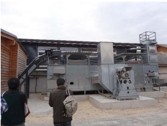
ボイラーの熱でペレット原料を乾燥させる
