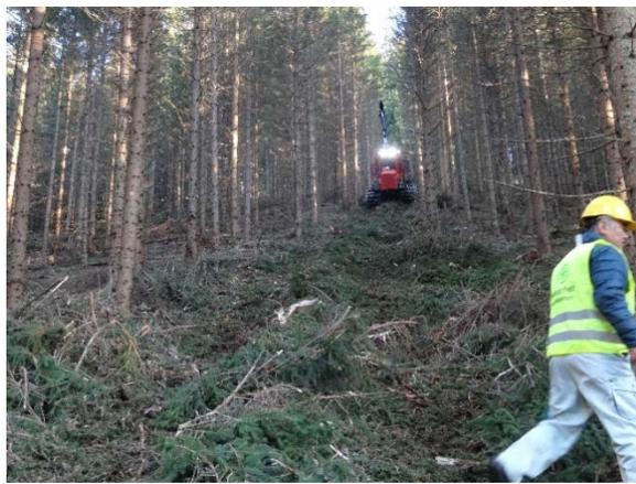
写真 登坂用ウィンチ付フォワーダ (30度程度の急勾配でも作業可能)
