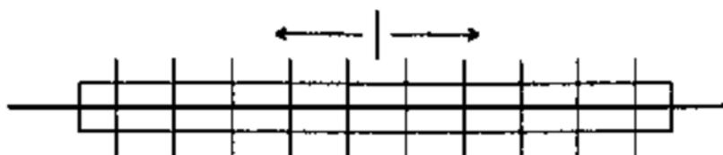
図3-12-1 ボルト締付け順序
