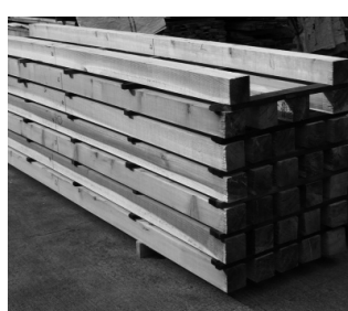
写真2 人工乾燥後の正角材
