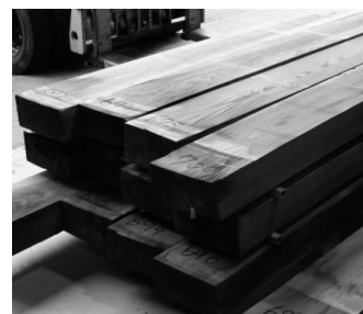
写真3 人工乾燥後の平角材
