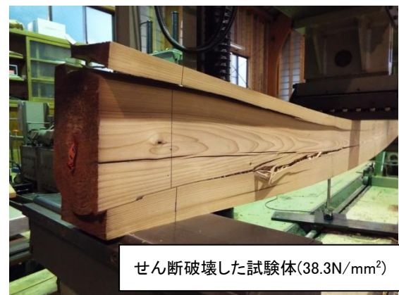
写真-2 曲げ強度試験による破壊の様子 (B : 蒸気・圧力併用型乾燥)
