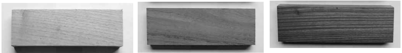
写真-22 左から中温乾燥材、高温乾燥材、120℃過熱水蒸気処理材の対比写真
