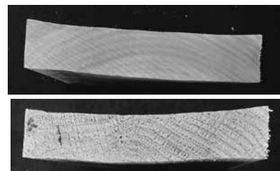
写真-5 糸巻き状変形と内部割れ (上段サクラ、下段コナラ)
