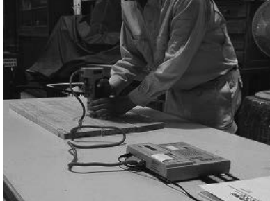
写真-11 材色計測の状況
