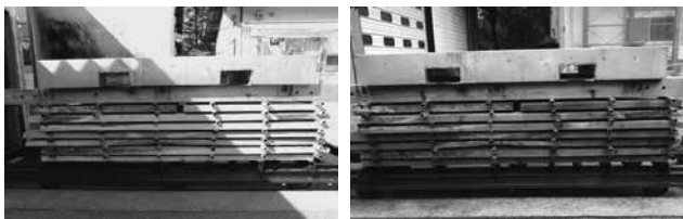
写真-24 過熱水蒸気処理前(左)と後(右)の対比
