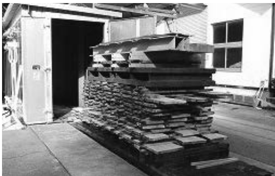
写真-1 蒸気式木材乾燥による 70°C中温乾燥
