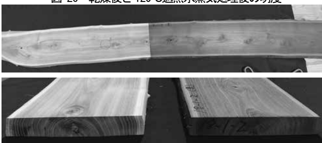
写真-21 80°C中温乾燥材(左)と120°C過熱水蒸気処理材(右)
