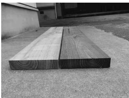
写真-25 過熱水蒸気処理前(左)と後(右)の対比
