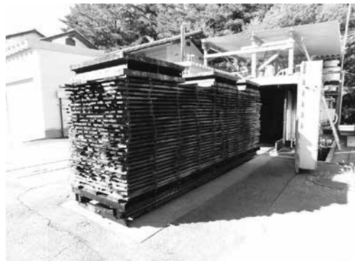
写真-14 過熱水蒸気処理後の状況
