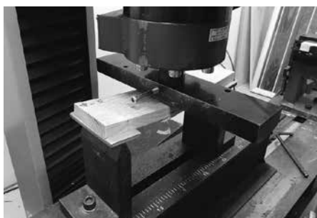
写真-15 曲げ強度試験状況
