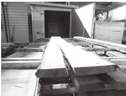
写真-8 木口割れの状況 (キハダ)
