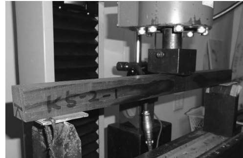
図-4 曲げ強度試験の方法
