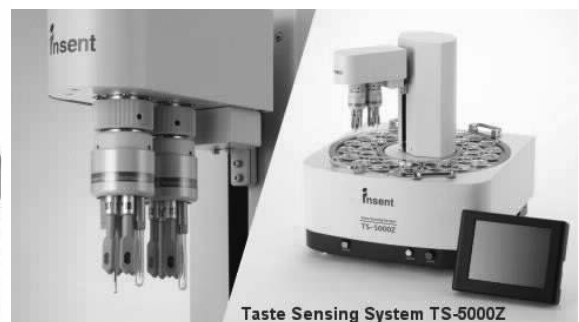
写真-1 味認識装置 (株) インテリジェントセンサーテクノロジー製 TS-5000Z 5)
