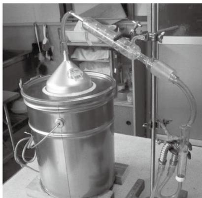
写真-9 ペール缶式精油採取装置 (容量: 20L、100V・750w)
