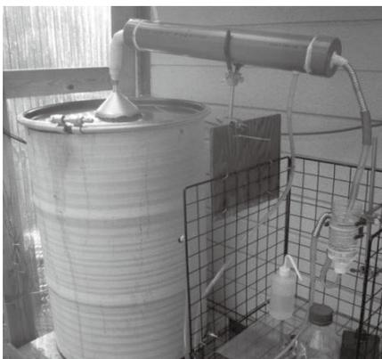
写真-8 ドラム缶式精油採取装置 (容量 200L、200V・3kw)
