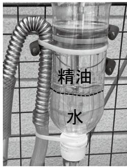
写真-11 ペットボトルを使用した精油回収容器
