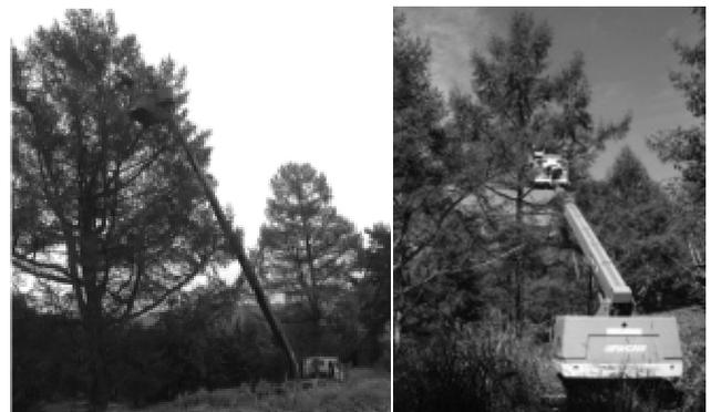
写真 5-1 高所作業車（左：トラック式アーム長 23m・右：クローラ式作業床 21m）
