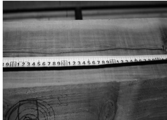
写真 4 正角材乾燥後材面割れ
