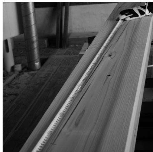
写真 6 平角材モルダー加工後の材面割れ
