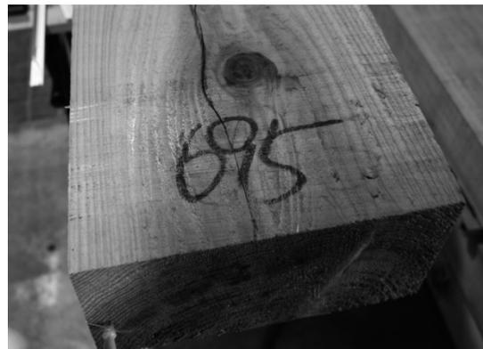
写真 5 平角材乾燥後材面割れ
