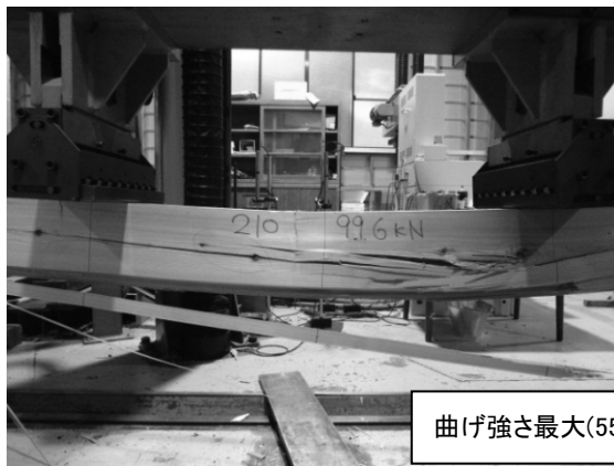
写真-1 曲げ強度試験による破壊の様子 (A : 弱加圧型高温乾燥)
