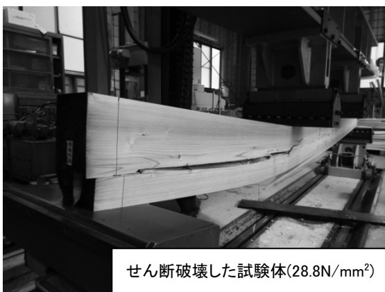
写真-4 曲げ強度試験による破壊の様子(D:高温セット+高温型)
