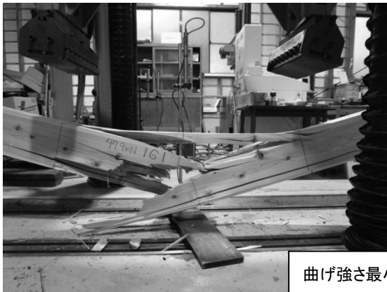
写真-3 曲げ強度試験による破壊の様子(C:高温セット+中温型)
