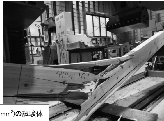
写真-3 曲げ強度試験による破壊の様子(C:高温セット+中温型)
