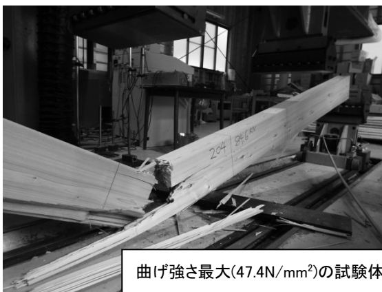
写真-3 曲げ強度試験による破壊の様子(C:高温セット+中温型)
