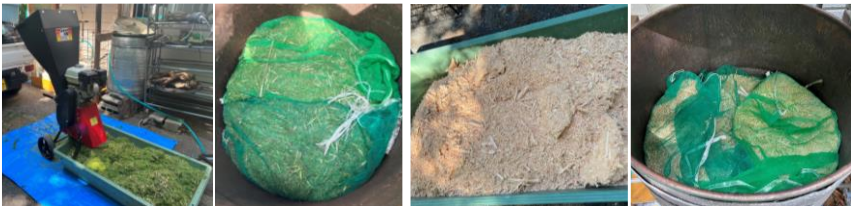
カラマツ枝葉をチップ機で粉碎、ネットに入れ蒸留器に仕込む
