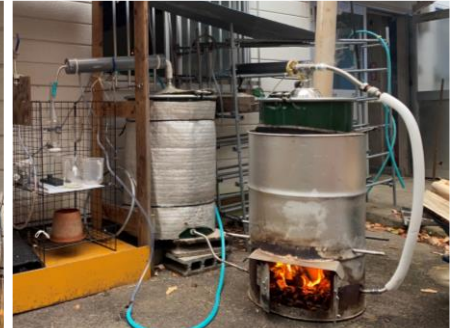
ドラム缶式精油抽出装置(薪焚き・ボイラー式)
