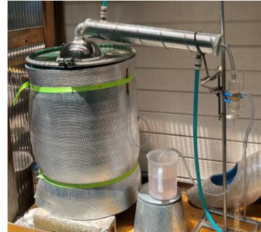
ドラム缶式精油抽出装置(電気式、200V・3KW)
