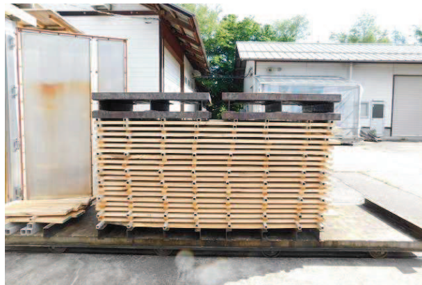
写真-2 栈木間隔 300 mmとした乾燥
