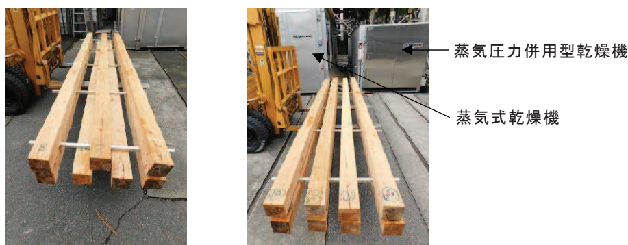
図-1 乾燥前の試験体（左：蒸気高温セット、右：減圧蒸気高温セット）
