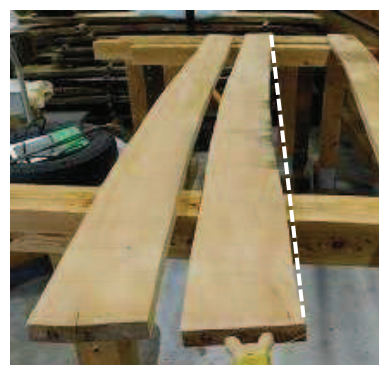
写真-3 曲がり状況
