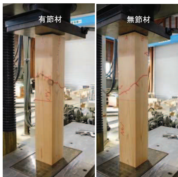
写真-1 正角材の圧縮試験状況（载荷速度 2 mm/分）
