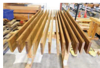
写真-2 屋内における養生
