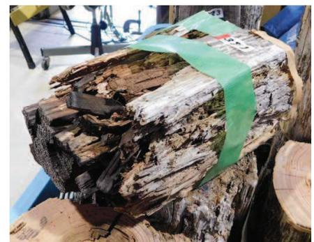
写真-2 袖部の埋設部材
