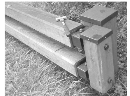
写真7 信州型木製 Gr 2号型 (カラマツ角材+鋼棒)
