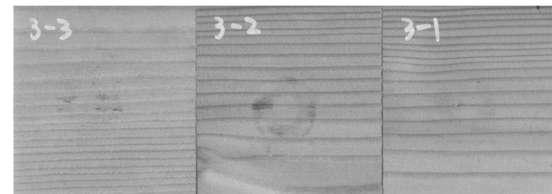
溶剤型 1 液性ウレタン → 鉄汚染あり (少々) (水系アクリルも同等の鉄汚染あり)
