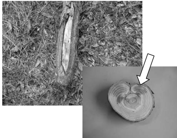
写真-4 樹皮剥皮部分から発生した変色と腐朽
