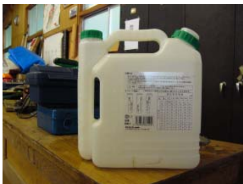
(ガソリン混合用容器 左側にオイル、 右側にガソリンを入れて混合する)
