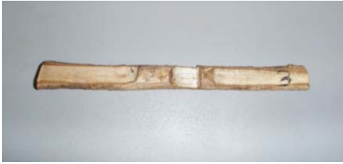
写真-1 加工した試験片を上から見た図
