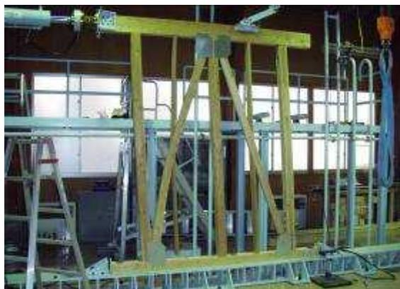
写真-1 筋かいによる耐力壁の面内せん断試験
