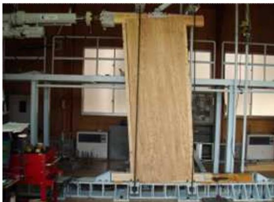
写真-3 面材料(合板)による耐力壁の面内せん断試験
