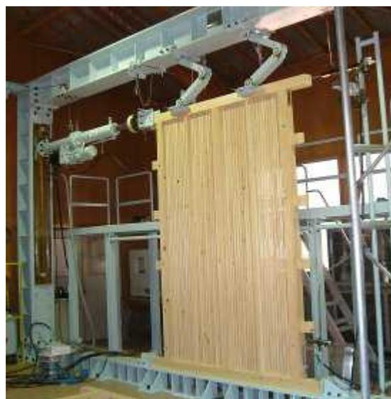
写真-2 貫による耐力壁の面内せん断試験
