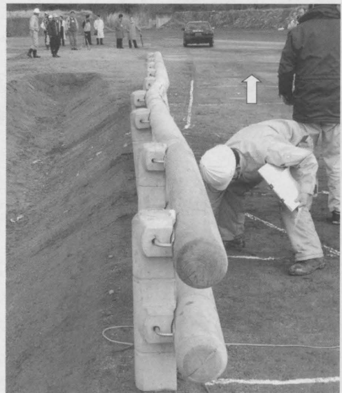
写真5 実車衝突試験の合格例 （上：大型貨物車、下：乗用車、 矢印：車両の進行方向）
