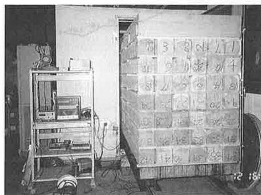
高温高速乾燥機によるカラマツ柱材の乾燥
