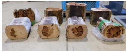
図-2 2023.9(設置後約20年)に部材交換を実施(黄色線囲み部)した岡谷市の施設(左)と、同袖部材の心材腐朽状況(右)
