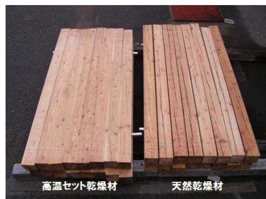
写真 高温セット法による材面割れ防
