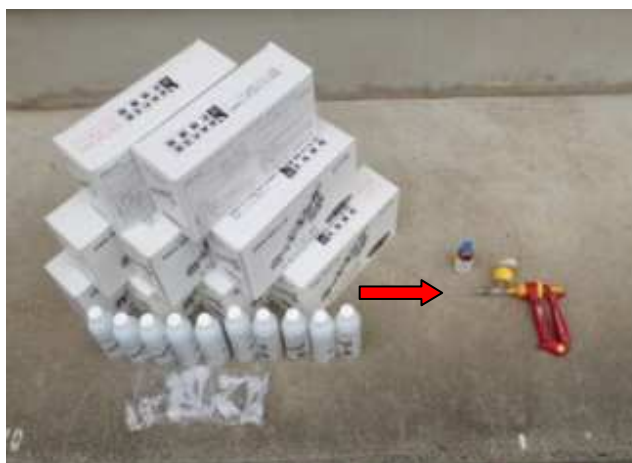
注入孔 100 個の処理に必要な薬剤量の比較 左：従来薬剤 右：ウッドキング DASH
