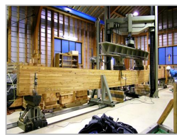
実大材曲げ試験
