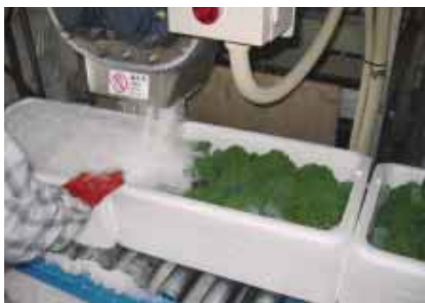
ブロッコリーの氷詰め出荷による鮮度保持
