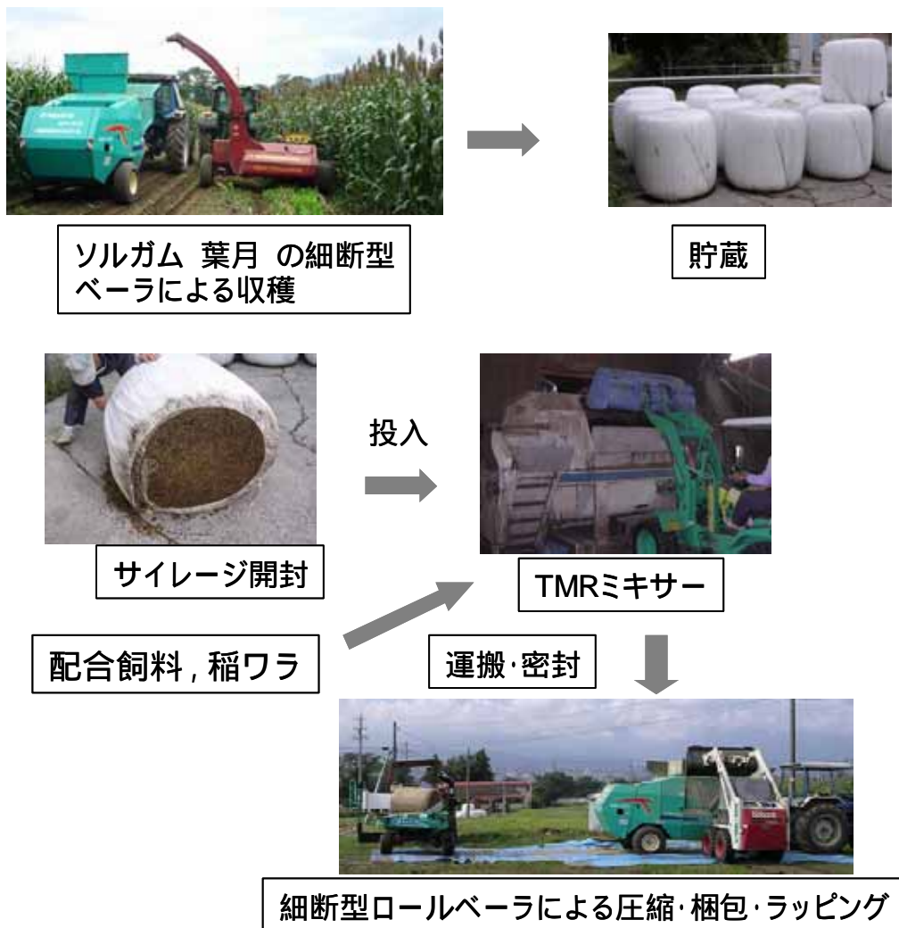
図1. 細断型ロールべーラを利用したソルガム 葉月の収穫と「発酵TMR」調製工程
