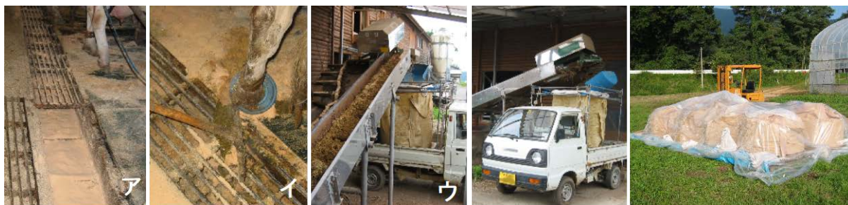
写真 バーンクリーナーを利用した原料の調整と投入方法及び野外での保管方法
