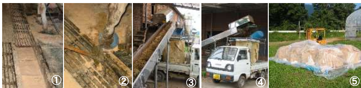
写真 バーククリーナーを利用した原料の調整と投入方法及び野外での保管方法
