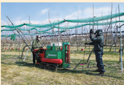
グロースガン(土壌に圧縮空気を打ち込む機械)による土壌改良
