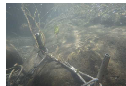
抜けたアンカーの様子 (水中)
