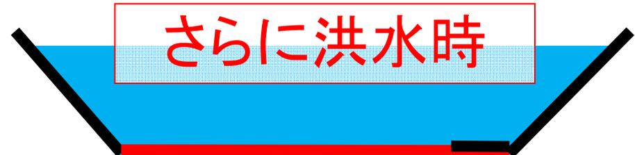
※中規模出水時、縦浸食は無いが、横浸食で高水敷の河岸が流失する
